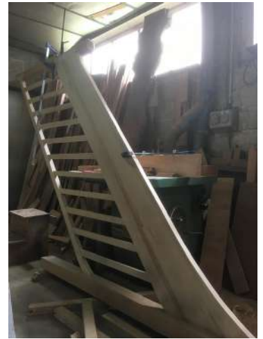
Illustration 23: Escalier en cours de fabrication
